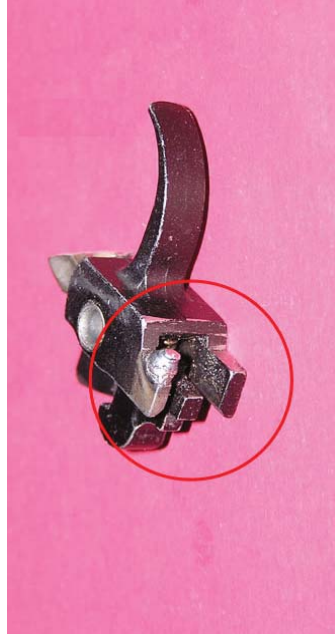
Eruvetoa rajoittava hitsi ympyröitynä. Tässä laukaisukoneistossa oli valmiina jälkivetoa rajoittava osa, jota vielä parantelin niin, että jälkivetoa ei ole käytännössä lainkaan.
